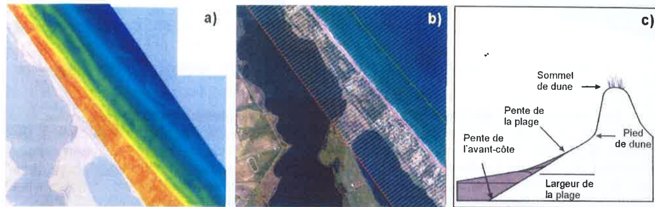
Illustration 5 – Utilisation du levé Lidar pour le calcul des variables morphologiques : a) extrait du modèle numérique de terrain ; b) discrétisation du littoral tous les 50 m ; c) variables morphologiques utilisées (Balouin et al. , 2011).
